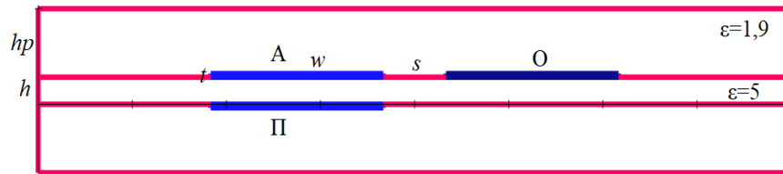
Рис. 1 – Поперечное сечение МФ с лицевой связью для СШЭП КА, где А – активный проводник, П – пассивный проводник и О – опорный проводник
