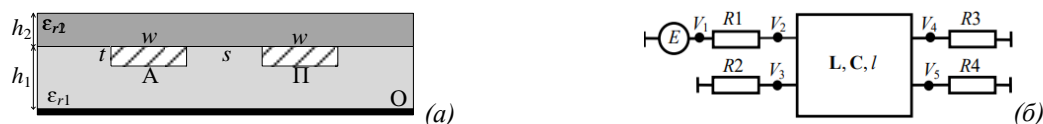
Рис. 1. Модель структуры ПП с проводниками на внутреннем слое (а), где проводники А – активный, П – пассивный, О – опорный; принципиальная электрическая схема (б)
