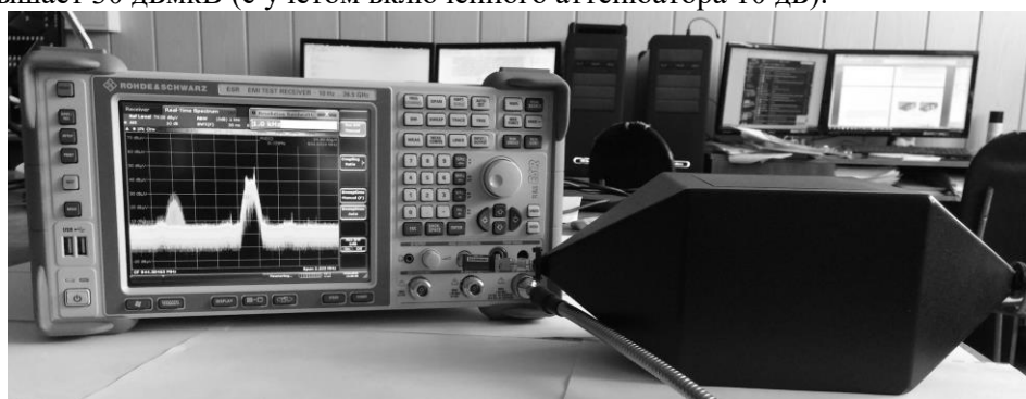
Рис. 7. Измерение эмиссии ЭМП от сотового телефона в ТЕМ-камере
