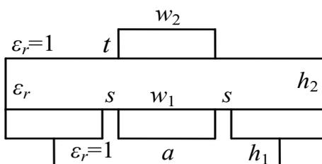
Рис. 2. Поперечное сечение связанных микрополосковой и копланарно–желобковой линий
