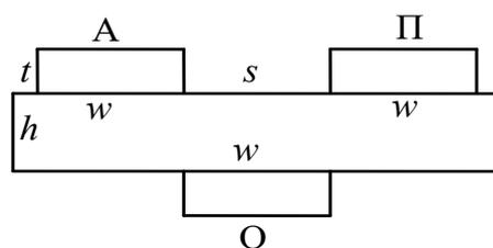
Рис. 3. Поперечное сечение устройства защиты от импульсных сигналов с выравниванием амплитуд разложенных импульсов.
