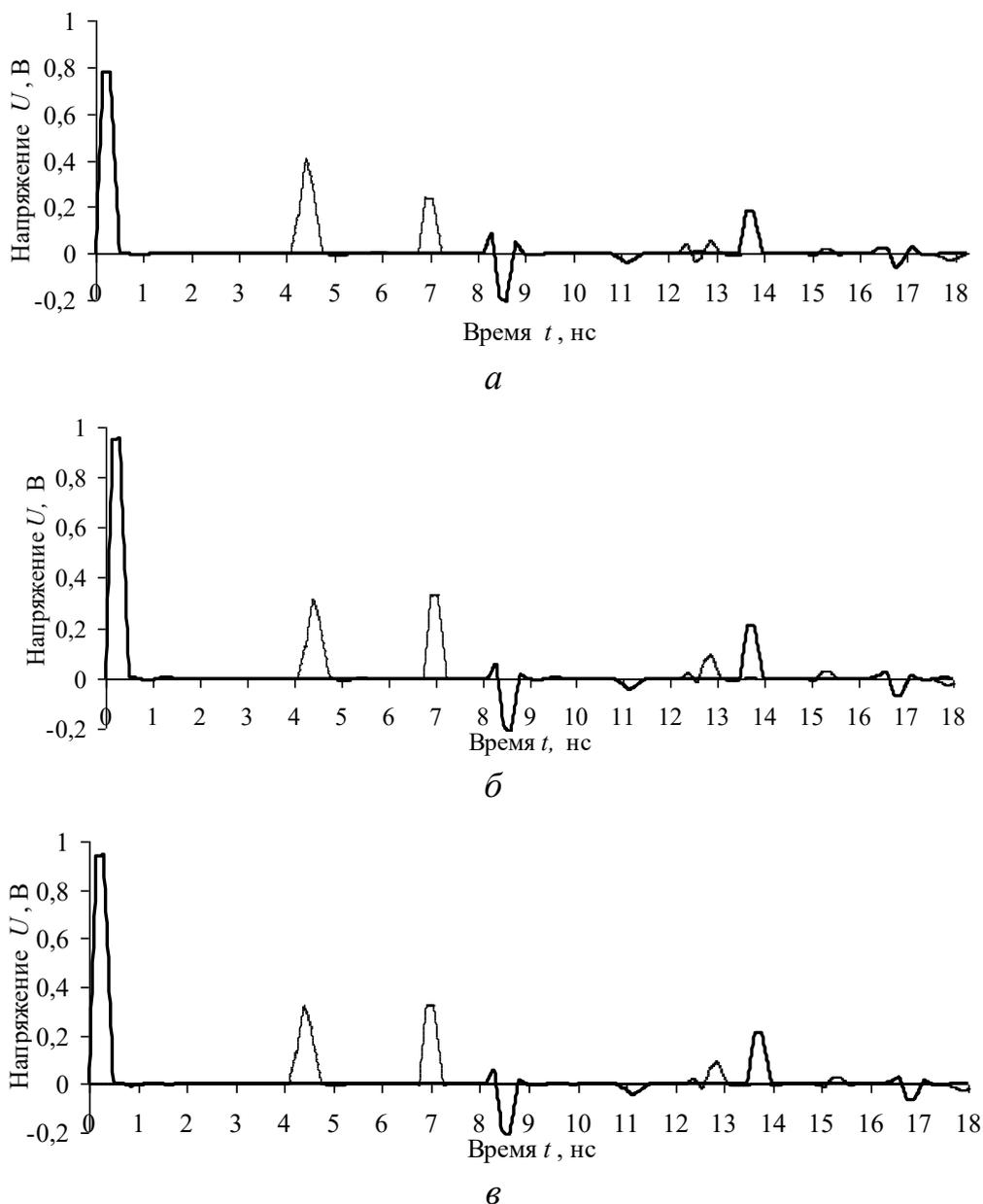
Рис. 5. Формы напряжения в начале (—) и конце (---) активного проводника предлагаемой структуры при  $R=100$  (а), 59 (б), 61 (в) Ом
