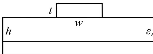
Рис. 1. Поперечное сечение микрополосковой линии
