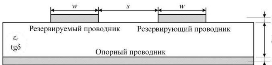
Рис. 2. Поперечное сечение МПЛ с однократным МР
