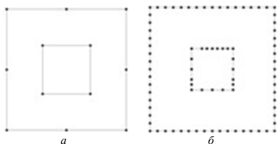
Рис. 6. Подынтервальные сетки коаксиальной линии передачи с прямоугольным поперечным сечением с числом сегментов 12 (а) и 148 (б)
