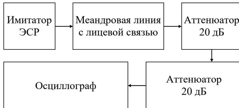
Рис. 17. Схема экспериментальной установки для проведения натурных испытаний
