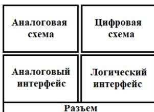
Рис. 7. Расположение аналоговых и цифровых блоков на печатной плате [3]
