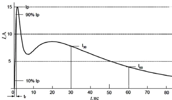
Рис. 3. Эталонный импульсный ток [1]
