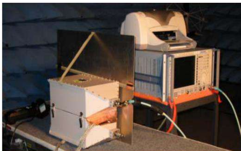
Рис. 11. Установка для измерения ЭМИ, генерируемого имитатором ЭСР
