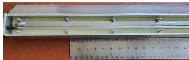
Рис. 9. Способ размещения ПП МФ в экранирующем корпусе
