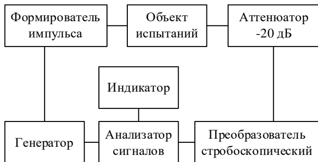
Рис. 11. Схема для измерений во временной области
