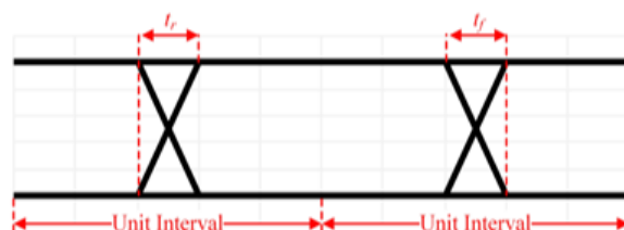
Рис. 3. Идеальные формы импульсов ПСБП
