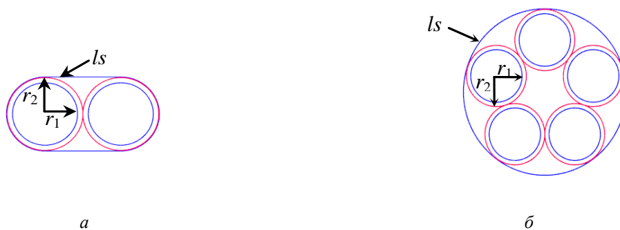
Рис. 4. Поперечные сечения центральных (отрезки 11–14 – a ) и боковых (отрезки 1–4 и 15–18 – б ) проводных отводов
