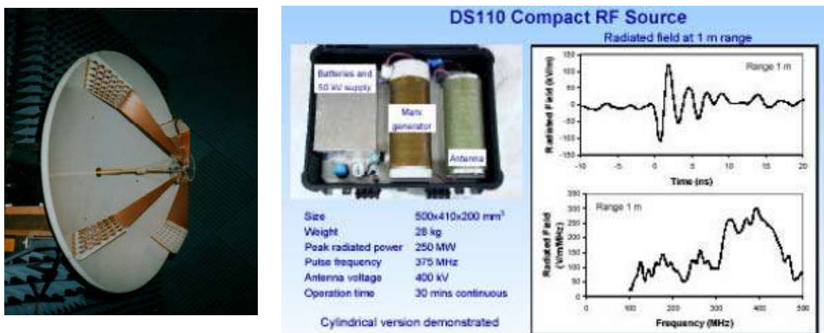
Рис. 3.7. Импульсная излучающая антенна от TNO (Нидерланды) ( a ) и компактный радиочастотный источник DS 110 от DIEHL (Германия) ( б )
