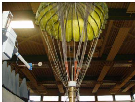
Рис. 3.4. Испытательная установка ( a ) для парашютной импульсной излучающей антенны ( б )
