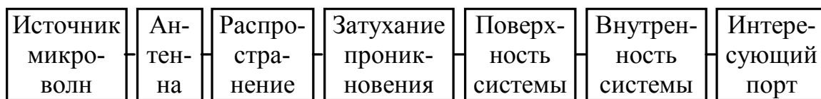
Рис. 6.1. Взаимодействие источника микроволн высокой мощности с типовой системой
