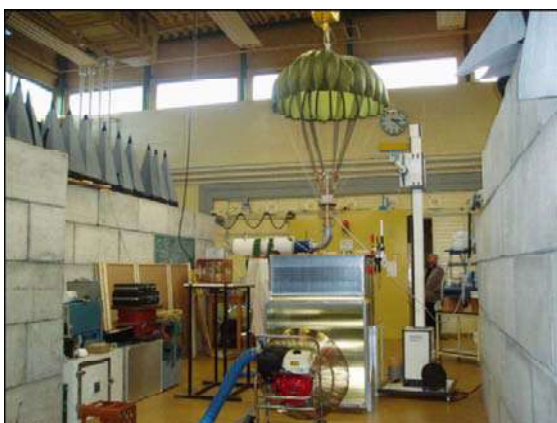
Рис. 3.4. Испытательная установка ( a ) для парашютной импульсной излучающей антенны ( б )
