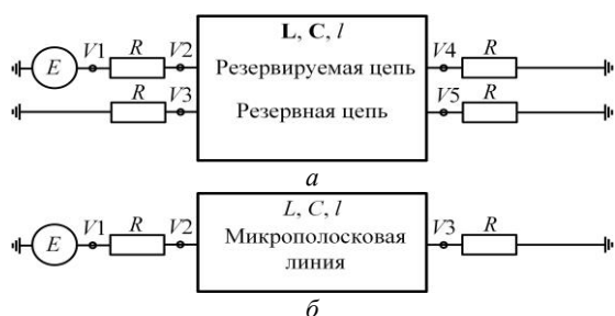
Рис. 2. Эквивалентная схема структуры с однократным МР (а) и без него (б)
