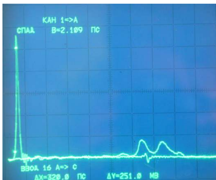
Рис. 3.91. Входное воздействие (импульс слева) и сигнал на выходе однокаскадного МФ (два импульса справа)
