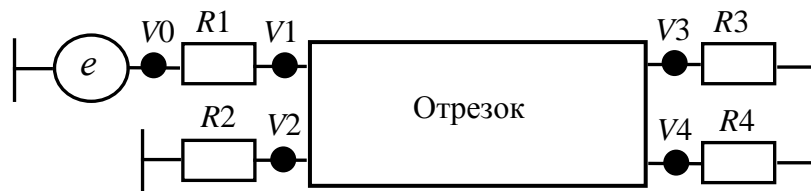
Рис. 2.2. Схема включения одиночного отрезка кабеля
