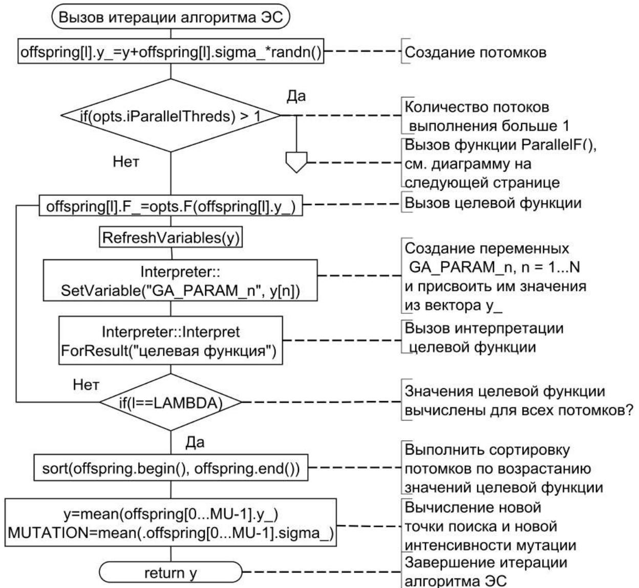
Рис. 3.29. Схема алгоритма функции  $ES()$
