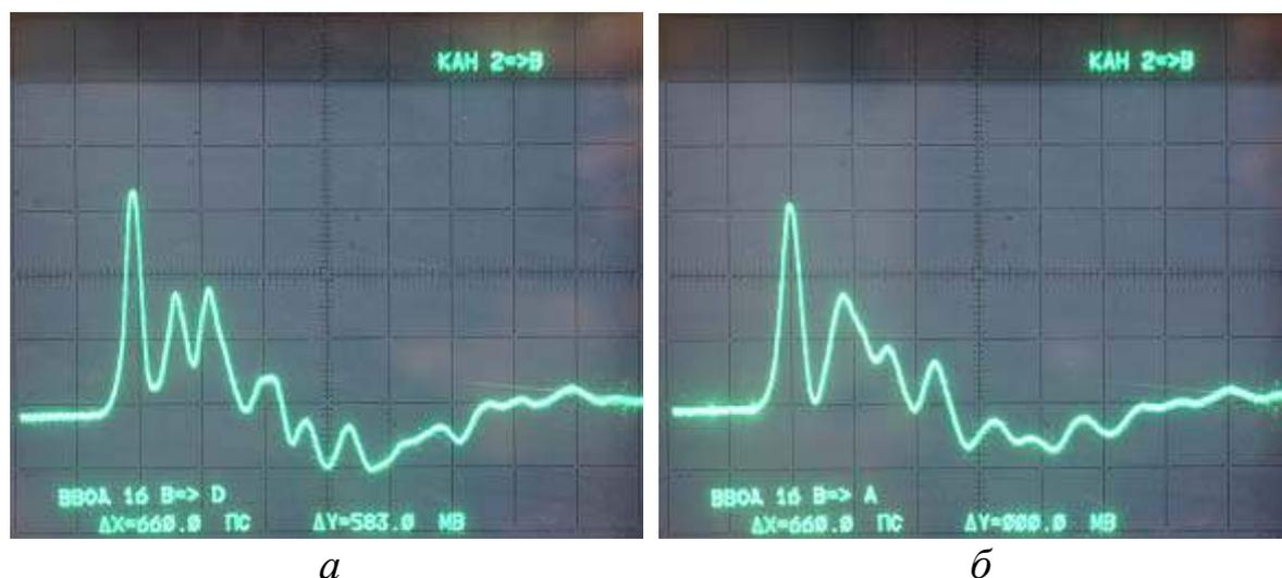
Рис. 4.12. Временной отклик макета 1 с учетом влияния SMA-разъемов (*а*) и без учета их влияния (*б*)
