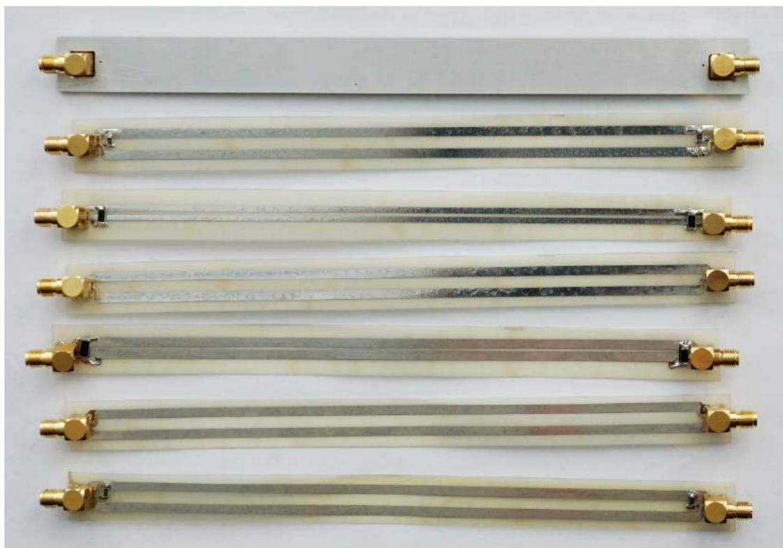
Рис. 4.8. Фотография макетов модальных фильтров
