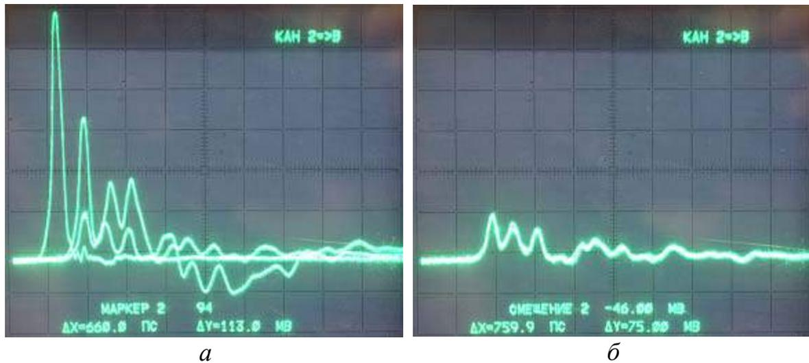
Рис. 4.15. Временные отклики макетов МФ 2 и МФ 1 с входным воздействием (а) и макетов МФ 2 и МФ 3 (б)
