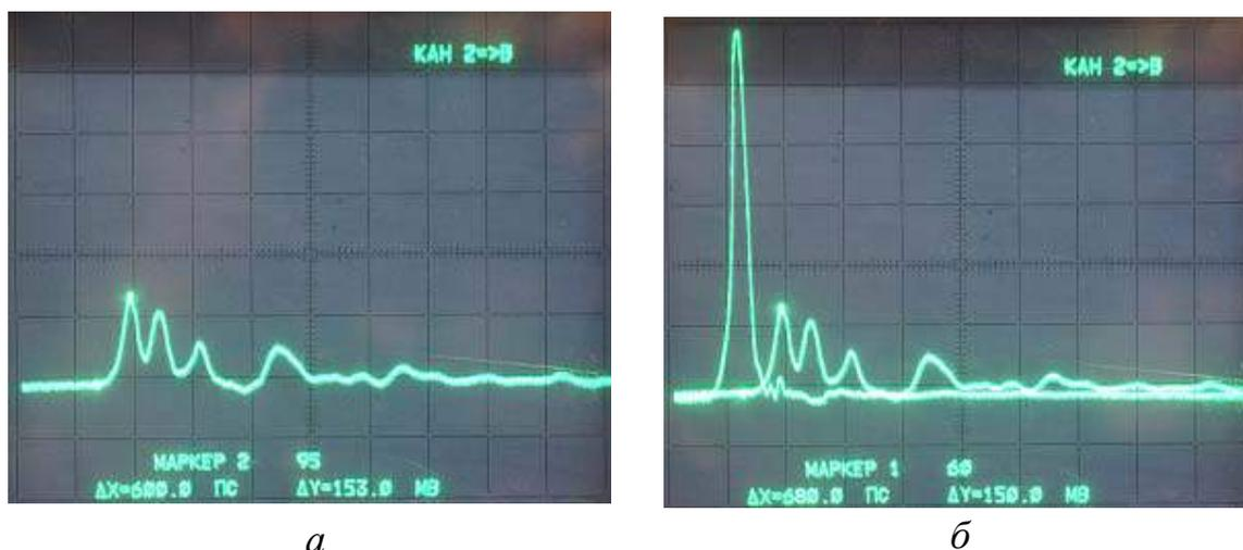
Рис. 4.19. Временной отклики макета МФ 7 отдельно (а) и с входным воздействием (б)
