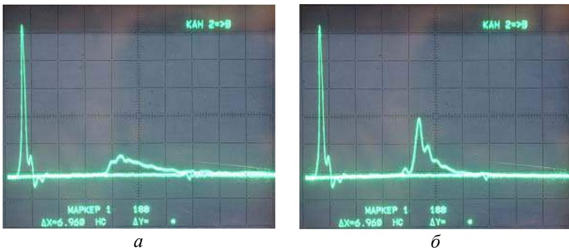
Рис. 5.54. Входное воздействие и временные отклики отрезка гибкого печатного кабеля для симметричной (*а*) и несимметричной (*б*) структур
