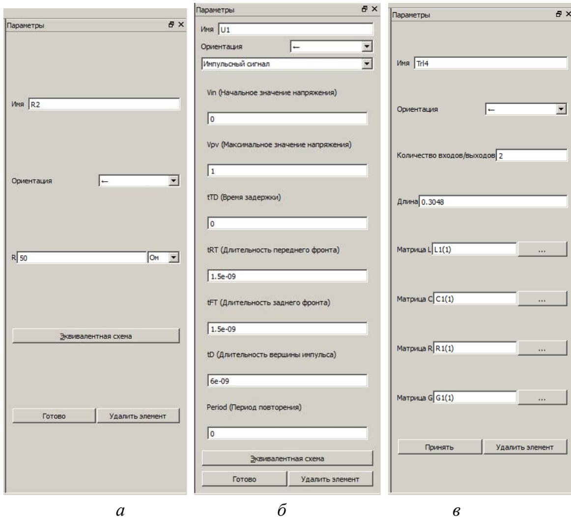
Рисунок 2.13 – Окно ввода параметров для резистора (а), импульсного сигнала (б), отрезка МПЛП (в)
