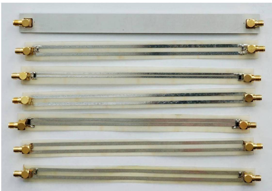
Рисунок 4.40 – Фотография макетов модальных фильтров
