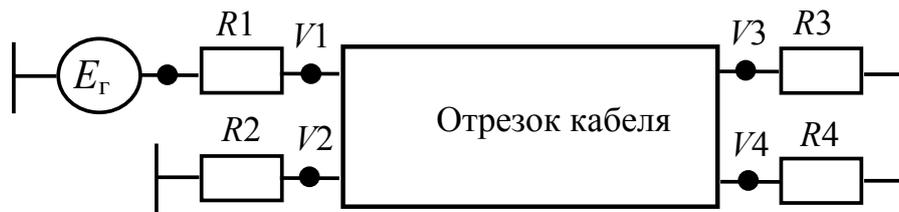
Рисунок 3.41 – Схема включения отрезка кабеля
