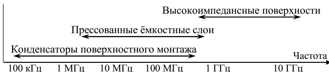
Рисунок 9.8 – Частотный диапазон различных методов уменьшения излучений системы «земля-питание»
