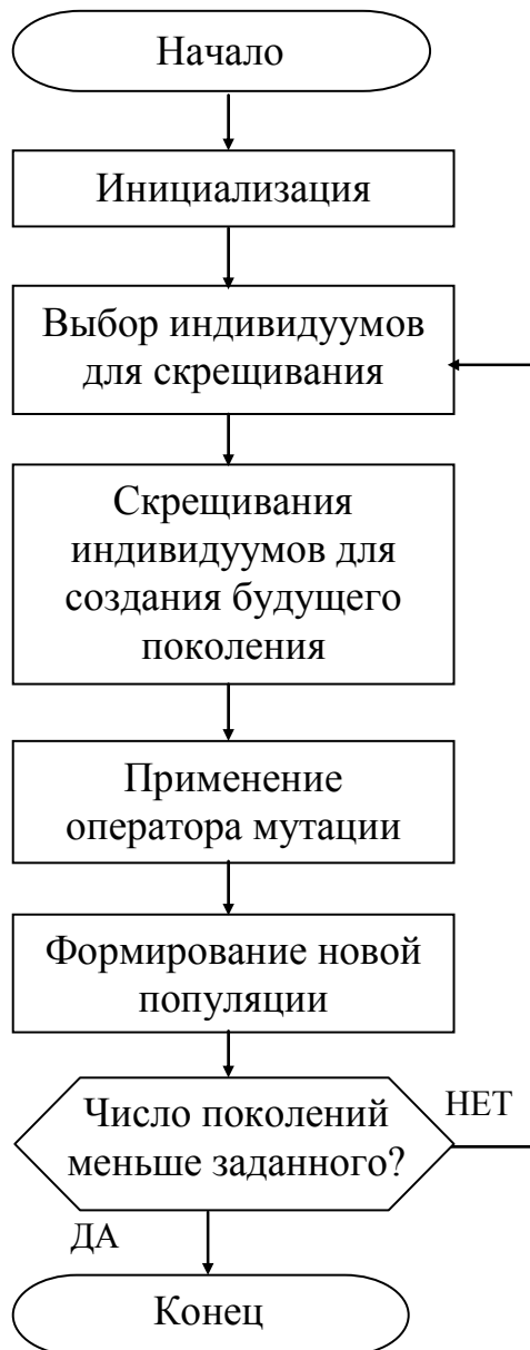
Рис. 3.2. Схема генетического алгоритма
