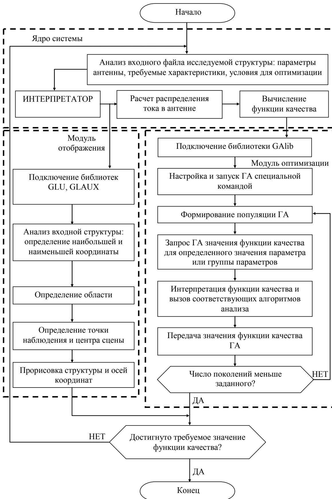
Рис. 3.14. Алгоритм работы программного обеспечения для моделирования проводных антенн с сосредоточенными нагрузками
