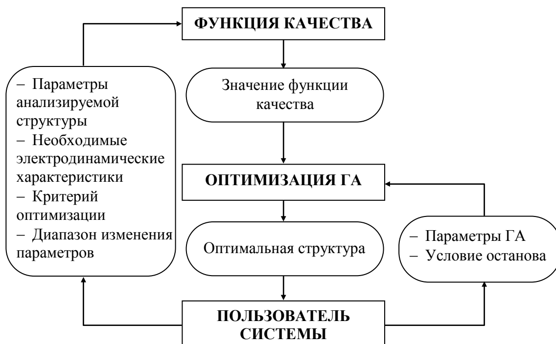
Рис. 3.12. Структура информационного обеспечения системы моделирования проводных антенн с нагрузками
