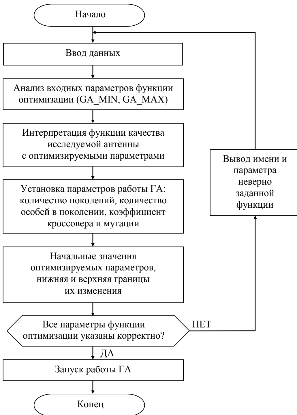
Рис. 3.13. Схема алгоритма настройки и запуска ГА в системе моделирования проводных антенн с сосредоточенными нагрузками
