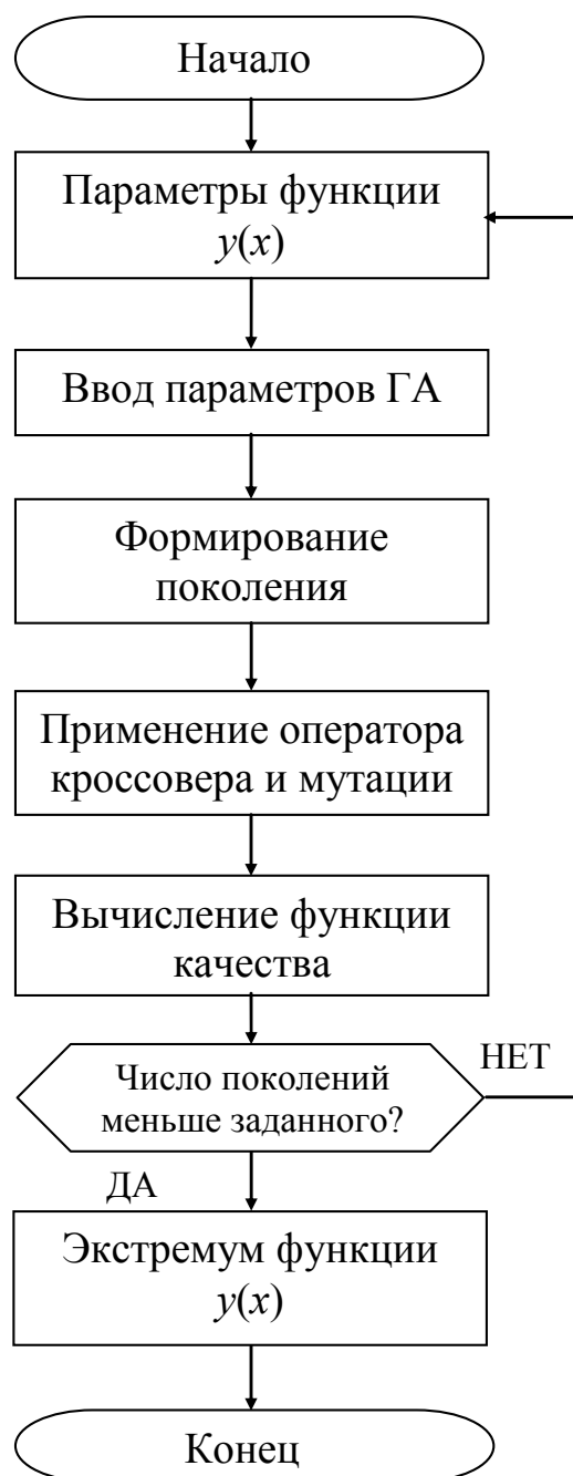
Рис. 3.3. Схема алгоритма программы поиска экстремума функции y(x) на основе работы генетического алгоритма
