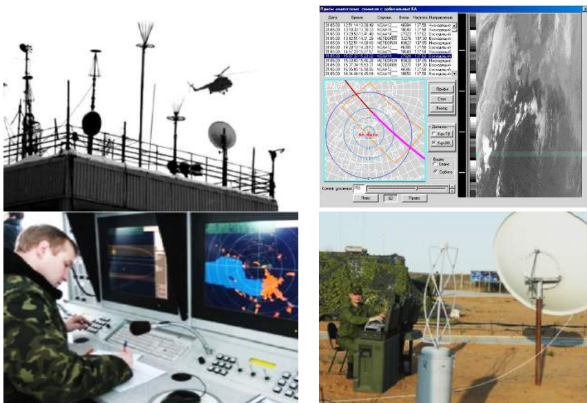
Рис. 1.2.23. Приёмная аппаратура и изображение на экране монитора метеорологической видеоинформации наземными комплексами «Сюжет»
