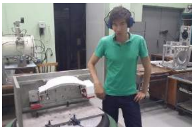
Рис. 3.1.2. Испытания на вибропрочность моноблока для скафандра
