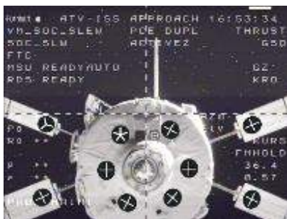
Рис. 3.4.3. Варианты реперов, включающие уголковые отражатели и катафоты
