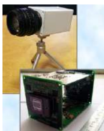
Рис. 3.2.16. Макетный образец ТВ камеры на ПЗС матрице формата 1920×1080
