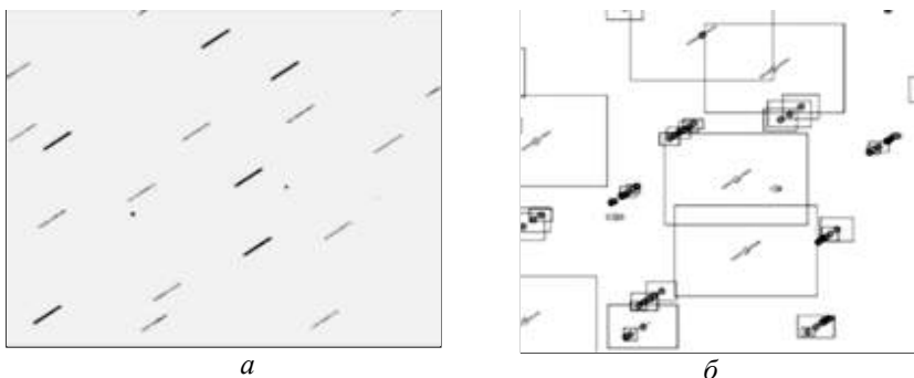
Рис. 2.2.6. Бинарный сигнал (треки слабых сигналов теряют слитность) – a ; авторегрессионное вычисление векторов смаза и стробы межкадровой обработки – б (всё – негатив)
