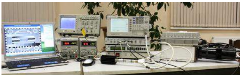
Рис. 3.1.13. Тестирование телевизионной системы контроля стыковки космических аппаратов с помощью контрольно-поверочной аппаратуры, изготовленной НИИ телевидения по заказу НАСА
