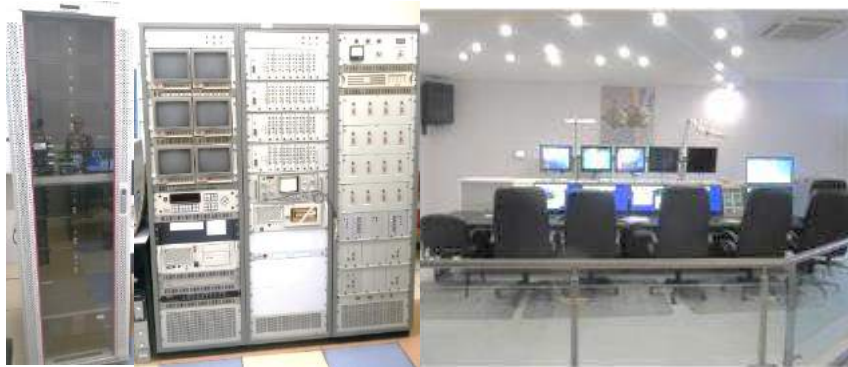
а б Рис. 3.8.1. ТВК «Сапфир» ( а ) и пульт контроля и управления тренажера ТПК «Союз» ТДК-7СТЗ с ТВК «Сапфир» ( б )
