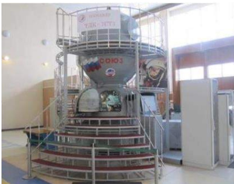
Рис. 3.8.2. Комплексный тренажер ТДК - 7СТЗ; аналогичный вид имеют комплексные тренажеры ТПК «Союз» ТДК-7СТ4, ТДК-7СТ5
