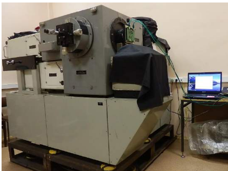
Рис. 3.1.14. Тестирование телевизионной ка меры с помощью имитатора звёздного неба ИЗН (разработки КМЗ им. Зверева)
