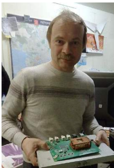
Рис. 3.3.7. EVC -кодер ( а ) и входящая в его состав микросхема 5022ВХ014 ( б )
