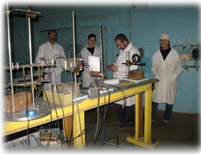
Рис. 3.1.6. Испытания ТВ камеры на ускорителе в ПИЯФ РАН на воздействие потока протонов и изображение с однокадровыми сигналами
