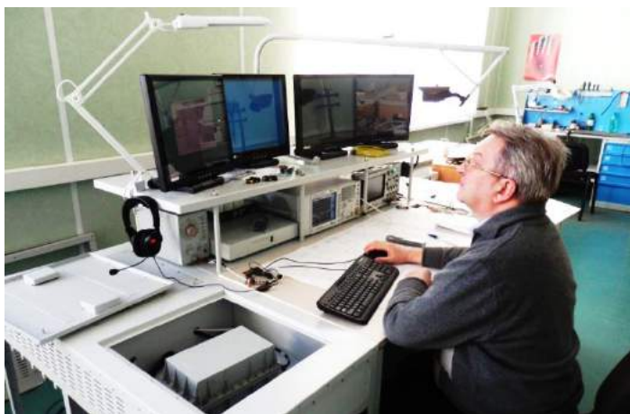
Рис. 3.3.6. Стенд для измерения задержек передачи видеoinформации
