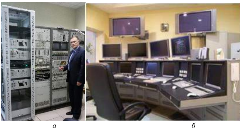
Рис. 3.8.4. ТВК «Фианит» (а) и пульт контроля и управления комплексного тренажера ТДК-7СТ4 с ТВК «Фианит» (б)
