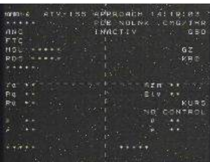
Рис. 3.3.5. Фрагмент видео с дефектами камеры, вызванными космической радиацией
