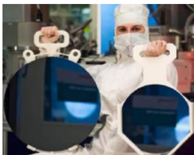
Рис. 4.3.1. Кремниевые пластины диаметром 450 мм и 300 мм
