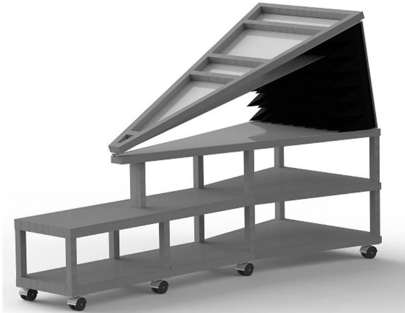
Рисунок 2.29 – Твёрдотельная модель открытой ГТЕМ- камеры на передвижной подставке для измерительных приборов
