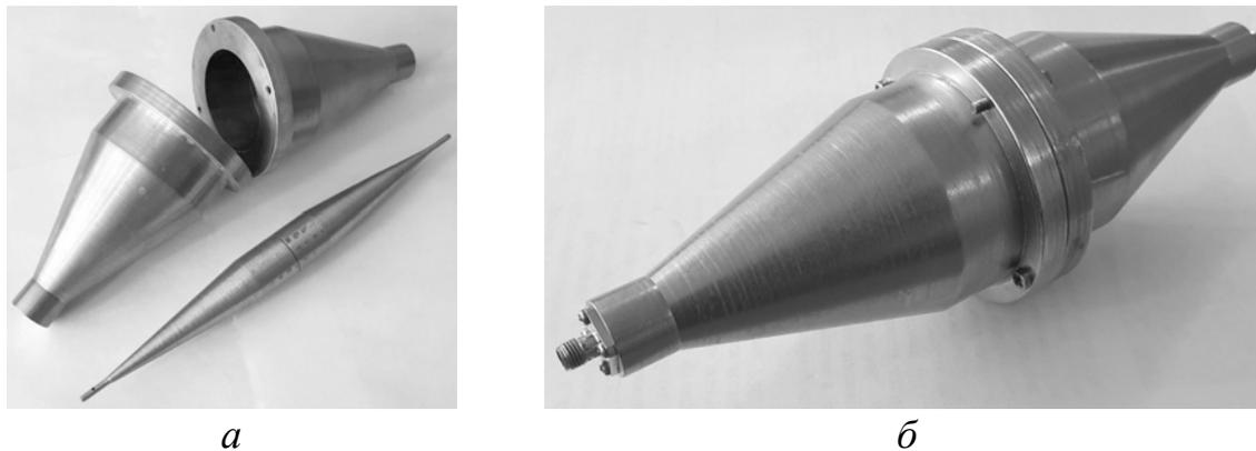
Рисунок 3.13 – Коаксиальная камера:
