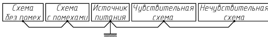
Рис. 18. Система заземления в виде гирлянды
