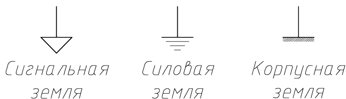
Рис. 12. Стандартные обозначения заземления
