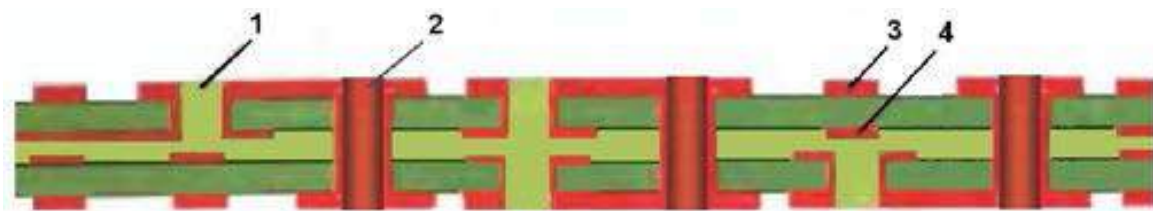
Рисунок 6.4 – Вариант структуры многослойной печатной платы, изготовленной методом попарного прессования:
