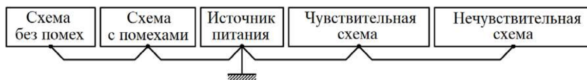
Рисунок 8.7 – Схема заземления в виде гирлянды
