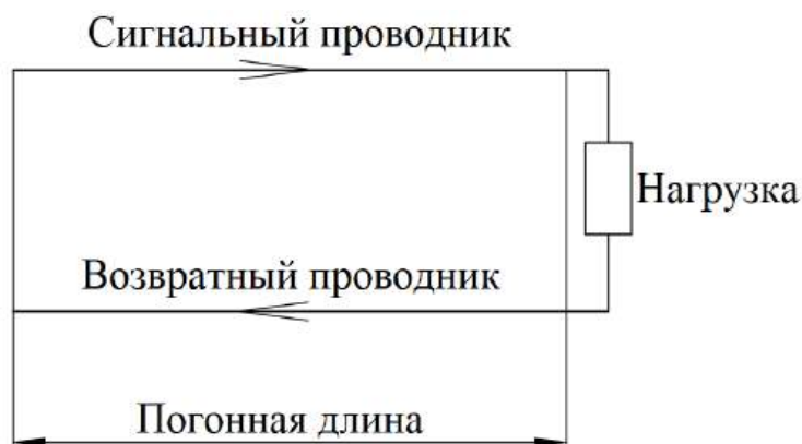
Рисунок 4.4 – Линия передачи из двух протяженных проводников
