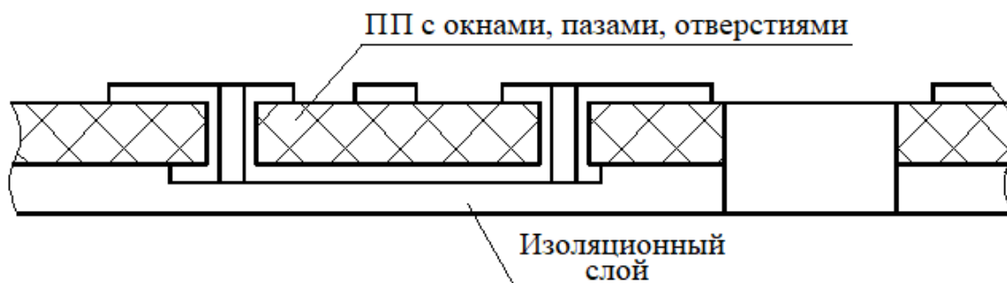
Рисунок 7.2 – Печатная плата с изоляционным слоем, окнами, пазами, отверстиями
