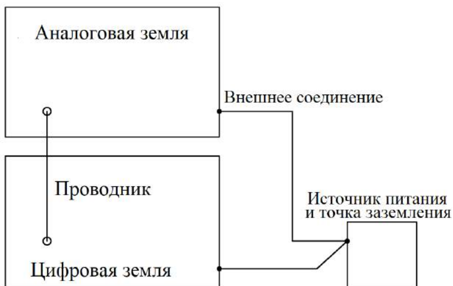
Рисунок 4.8 – Контур возвратных токов при разделении на две зоны
