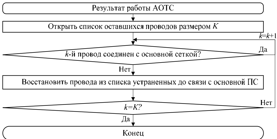
Рисунок 2.5 – Алгоритм работы САОТС
