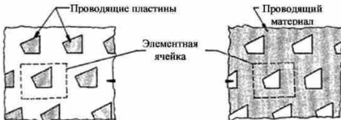
Рисунок 1.10 – Апертурная и патчевая периодические поверхности
