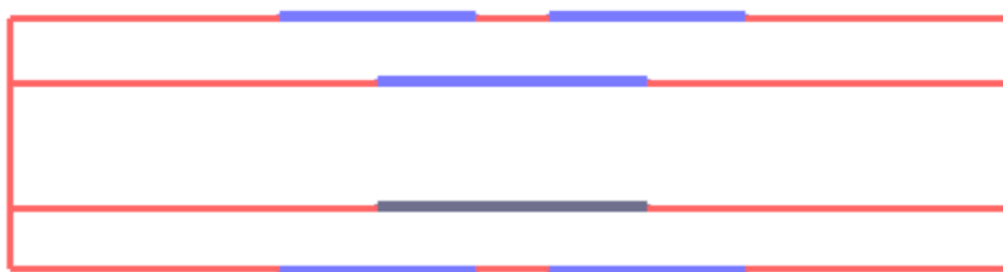
Рисунок 1.47 – TUSUR.EMC: структура с четырьмя проводящими слоями, один из которых опорный (без перемычек)
