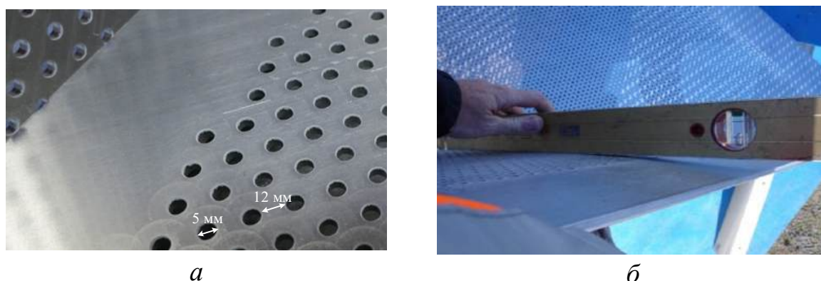
Рисунок 1.12 – Перфорированная поверхность (а) и деформация перфорированной поверхности ТТУО с L=1,5 м [6] (б)
