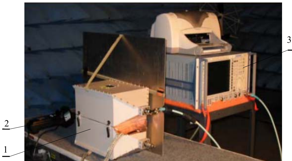
Рисунок 2.6 – Установка для измерения электромагнитного излучения, генерируемого имитатором ЭСР
