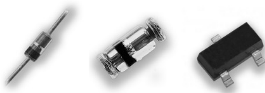
Рисунок 1.12 – Стабилитроны в различных вариантах исполнения
