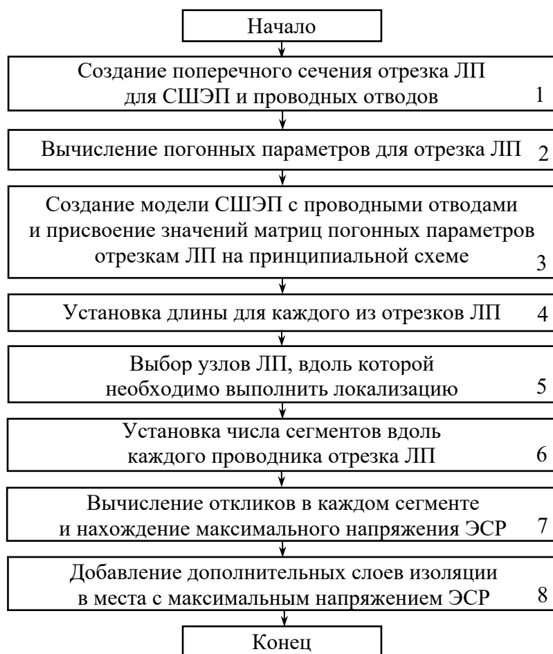
Рисунок 4.3 – Методика для анализа и локализации экстремумов воздействия ЭСР на СШЭП
